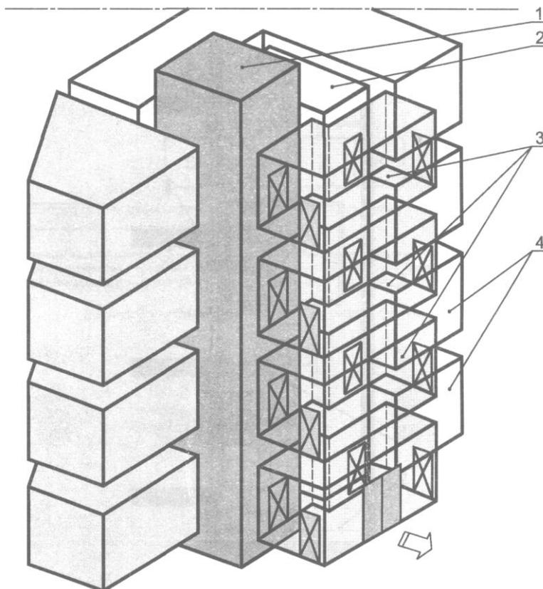
1 - лифтовая шахта, образующая отдельное пожарозащищенное помещение и проходящее через все этажи здания; 2 - лестница (путь эвакуации), образующая отдельное пожарозащищенное помещение и проходящая через все этажи здания; 3 - пожарозащищенные лифтовые холлы, каждый из которых образует отдельное пожарозащищенное помещение на каждом этаже; 4 - полезные площади здания, которые на каждом этаже могут иметь одно или несколько пожарозащищенных помещений
