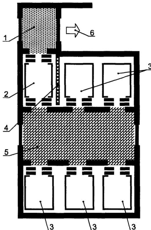
1 - пожарозащищенный холл лифта для пожарных; 2 - лифт для пожарных; 3 - обычные лифты; 4 - промежуточная огнестойкая стена в шахте лифтов; 5 - основной общий пожарозащищенный лифтовой холл; 6 - путь эвакуации
