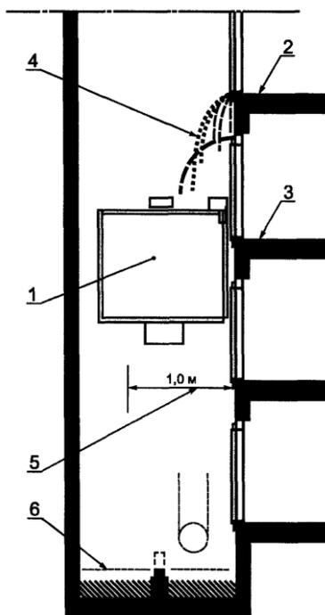
1 - кабина лифта для пожарных; 2 - этаж, на котором происходит тушение пожара; 3 - этаж передового пункта борьбы с пожаром; 4 - потоки воды; 5 - зона, в которой лифтовое
