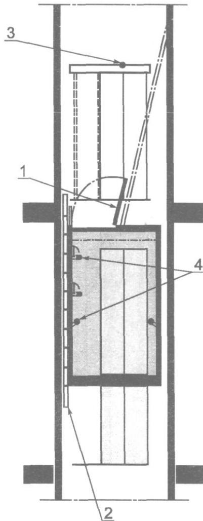
1 - люк; 2- переносная лестница, закрепленная снаружи кабины лифта; 3 - замок шахтной двери; 4 - точки в купе кабины, используемые в качестве опор
