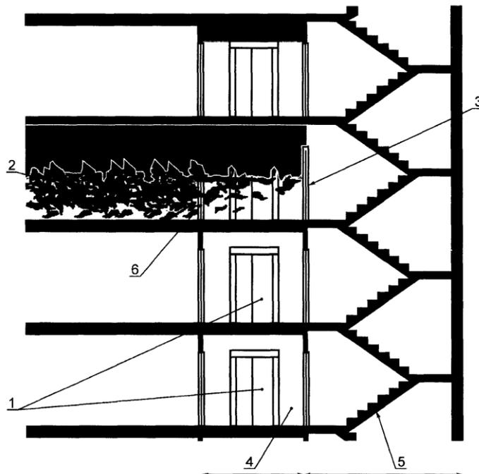
1 - лифт для пожарных; 2 - этаж пожара; 3 - огнестойкая дверь лифтового холла; 4 - пожарозащищенный лифтовой холл; 5 - лестница (путь эвакуации); 6 - разрушенная огнестойкая дверь или стена лифтового холла
