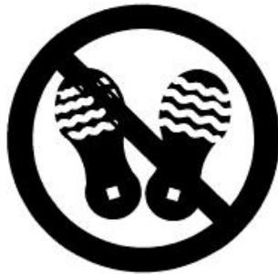
Рисунок 10 - Пример таблички-предупреждения, запрещающей наступать и ходить по потолочному перекрытию
