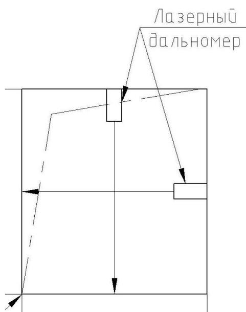
**11.63 При выполнении измерения максимальной величины ускорения (замедления) движения кабины лифта при эксплуатационных режимах и при экстренном торможении (п. 4.8 ГОСТ Р 53780-2010) специалист в соответствии с п. Б.11 ГОСТ Р 53781-2010 выполняет следующие действия. Измерения следует выполнять при размещенном в кабине лифта груза 75 кг. Следует установить прибор измерения ускорения горизонтально на пол кабины лифта нажав клавишу выбора режима переводим прибор в режим измерения ускорения.**
